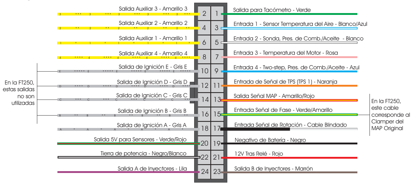
Vista Trasera del Conector del Arnés
